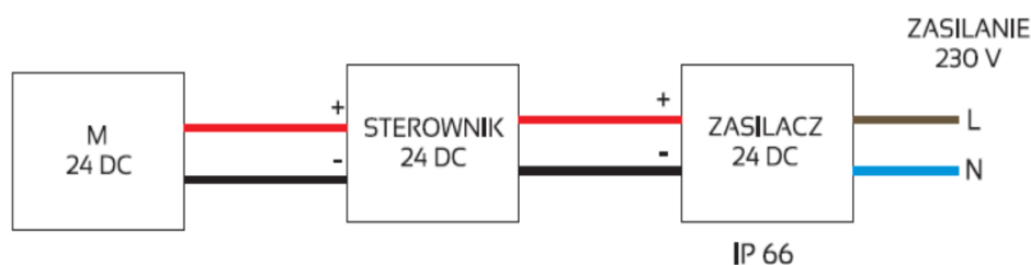
Rys.2 Schemat podłączenia silnika
