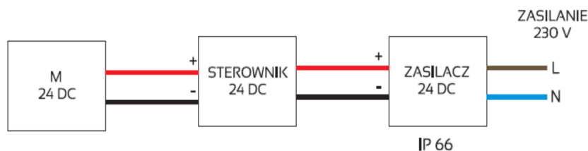
Rys.3 Schemat połączenia silnika
