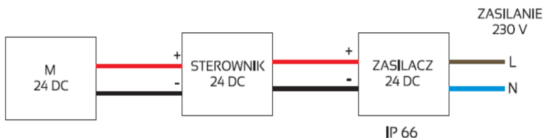
Rys.3 Schemat połączenia silnika
